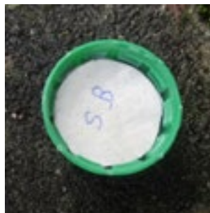
Mise en place d'un filtre dans le bouchon perforé
